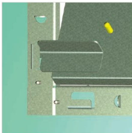
Détail de la charnière/Detail hinge
